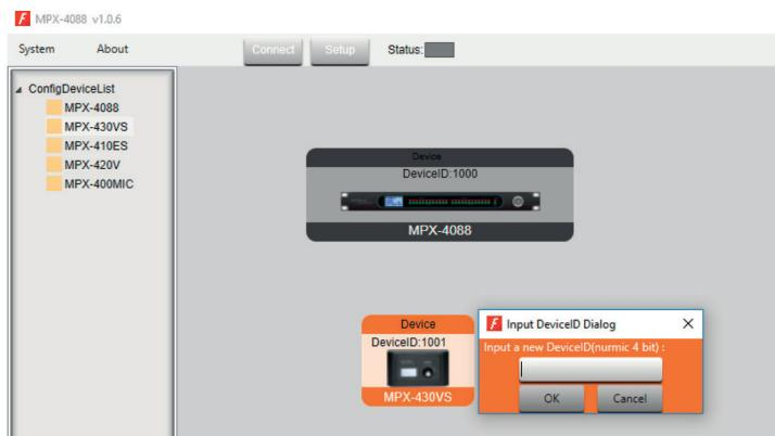
**2.- Star network mode :** permet la configuration et le contrôle individuel de plusieurs matrices **MPX-4088** connectées à un même routeur. Dans ce mode d'édition, le PC et la matrice **MPX-4088** doivent être connectés au routeur par câble RJ-45 et, le sélecteur LAN/RC-Net placé sur le panneau arrière de la matrice, doit être sur la position LAN.
