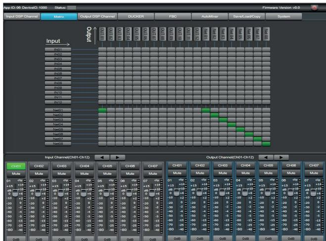
Dans ce cas, le canal NET 1 sera émis sur la sortie analogique 1 de la matrice.
