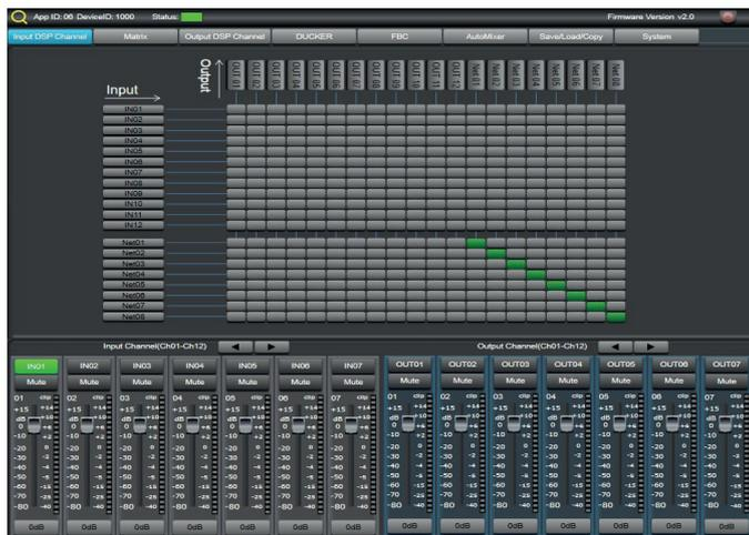
Lorsque nous voulons partager une entrée analogique d'une matrice dans les canaux NET (afin qu'elle soit visible et sélectionnable comme source audio par le reste des matrices de l'installation), nous devons sélectionner l'entrée analogique que nous voulons (IN01 à IN12), la marquer dans le canal (NET01 à NET 08) que nous voulons et la dé-marquer de la diagonale NET, comme suit :
